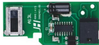
大灯调光控制PCBA 额定工作电压:12V 静态电流:<10mA 最大驱动电流:635mA (-40to+105°C) 行程:6.0±0.3mm (16.2%-85.2%UB) 外形尺寸: 53*24mm
