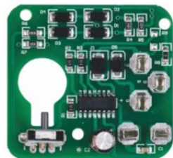
大灯调光控制PCBA 额定工作电压:24V 静态电流:<30mA 最大驱动电流:800mA 行程:5.5±0.3mm (17.2%-82.3%UB) 外形尺寸: 42.5*42.5mm
