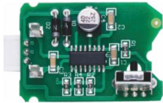
大灯调光控制PCBA 额定工作电压:12V 静态电流:<10mA 最大驱动电流:635mA (-40to+105°C) 行程:3.5±0.2mm (27.5%-90%UB) 外形尺寸: 40*28mm
